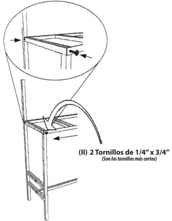
2.- Coloque la barra que sostiene los botes por abajo. Para botes Sablón de 65 litros, poner la barra en el travesaño de arriba y para los botes de 80 litros, ponerlo en el de abajo.
