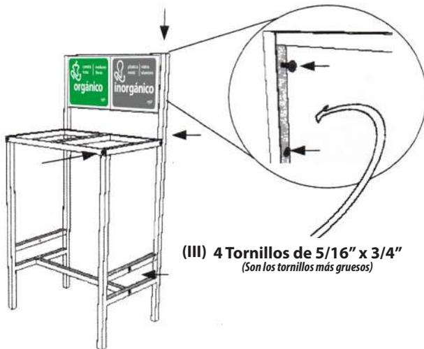
3.- Coloque el copete con los gráficos utilizando los 4 tornillos (III) en la parte de atrás, tal como se indica en el dibujo.
